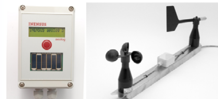
Abbildung 18: Messequipment zur Windpotenzialmessung (Datenlogger, Anemometer und Windfahne)
